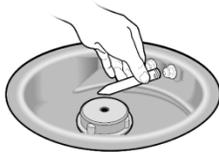
2 Tenez en place un tube de test de volume (petit tube) sur la buse sélectionnée.
