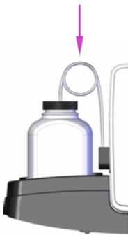
Une fuite de réactif sur la tubulure située entre la sortie de la pompe et la buse va provoquer une fuite de liquide à l'intérieur du boîtier de l'automate de coloration et, au final, sur la paillasse. Dans ce cas, l'instrument doit être réparé. Contactez votre distributeur ou ELITech Group pour obtenir de l'aide.
