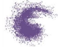
**REMARQUE :** Si le résultat du test de géométrie du spray est mauvais, nettoyez l'orifice de la buse avec la brosse à buse fournie dans le kit de maintenance des buses.
