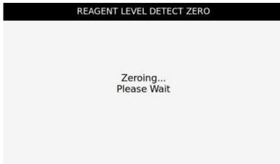
**REMARQUE :** Des vibrations ou des chocs portés à l'instrument ou à la paillasse peuvent entraîner des imprécisions dans la remise à zéro ou la calibration.
