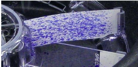
**Figure 15 : Résultat incorrect du test de projection sur lame**
